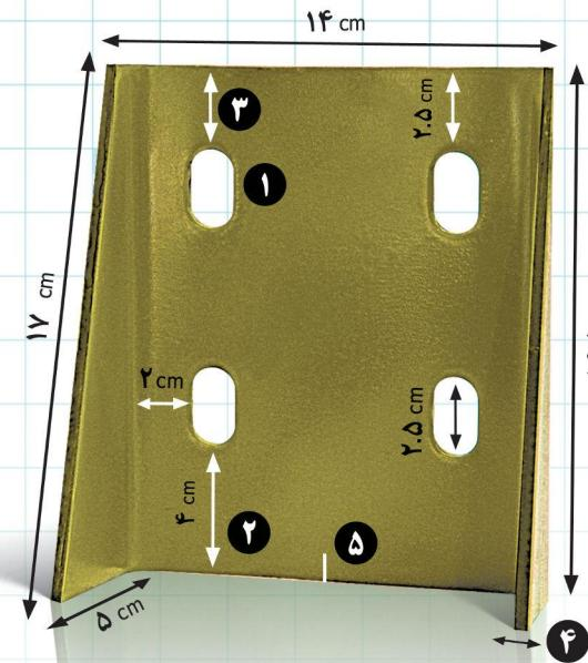
۱ به منظور نصب آسان زدها به زد بندها و راحت فیکس شدن محل پیچ، همانطور که در تصویر قابل مشاهده است سوراخ‌ها به شکل لوپیانی طراحی شده در حالی که در شکل سنتی به دلیل انجام سوراخ کاری با دریل این امکان وجود ندارد.
